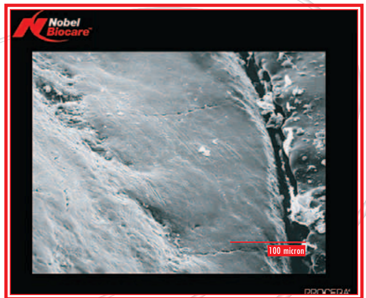
Sezione di una corona Procera® cementata su dente naturale al microscopio elettronico. Linea di riferimento 100 micron
